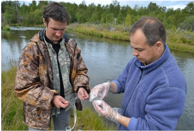
Установка устройств поглощения тяжелых металлов в воде, река Колос-йоки. А. А.Черепанов, С. С. Сандимиров, 2012 год
